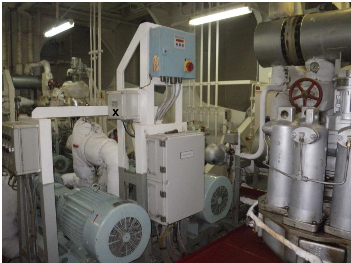
Abbildung 1: Maschinenraum eines Containerschiffs Messdaten-Abgriff an X vom Treibstoffverbrauch des Hauptantriebs
