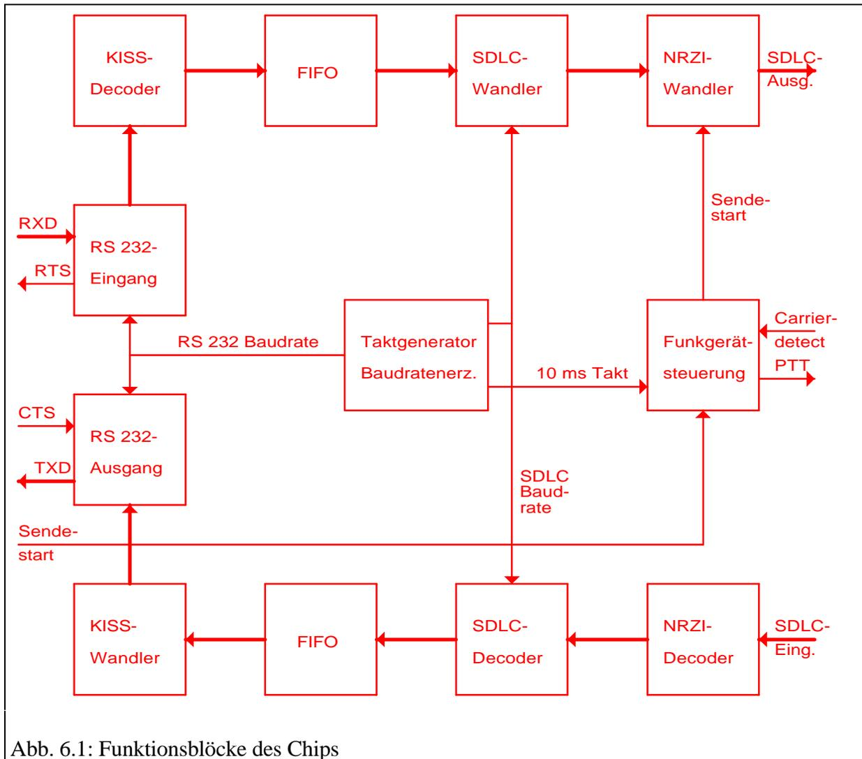
Abb. 6.1: Funktionsblöcke des Chips
