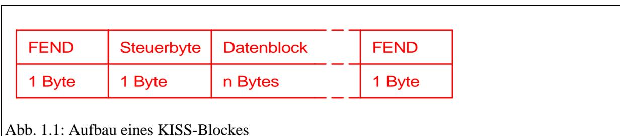
Abb. 1.1: Aufbau eines KISS-Blockes
