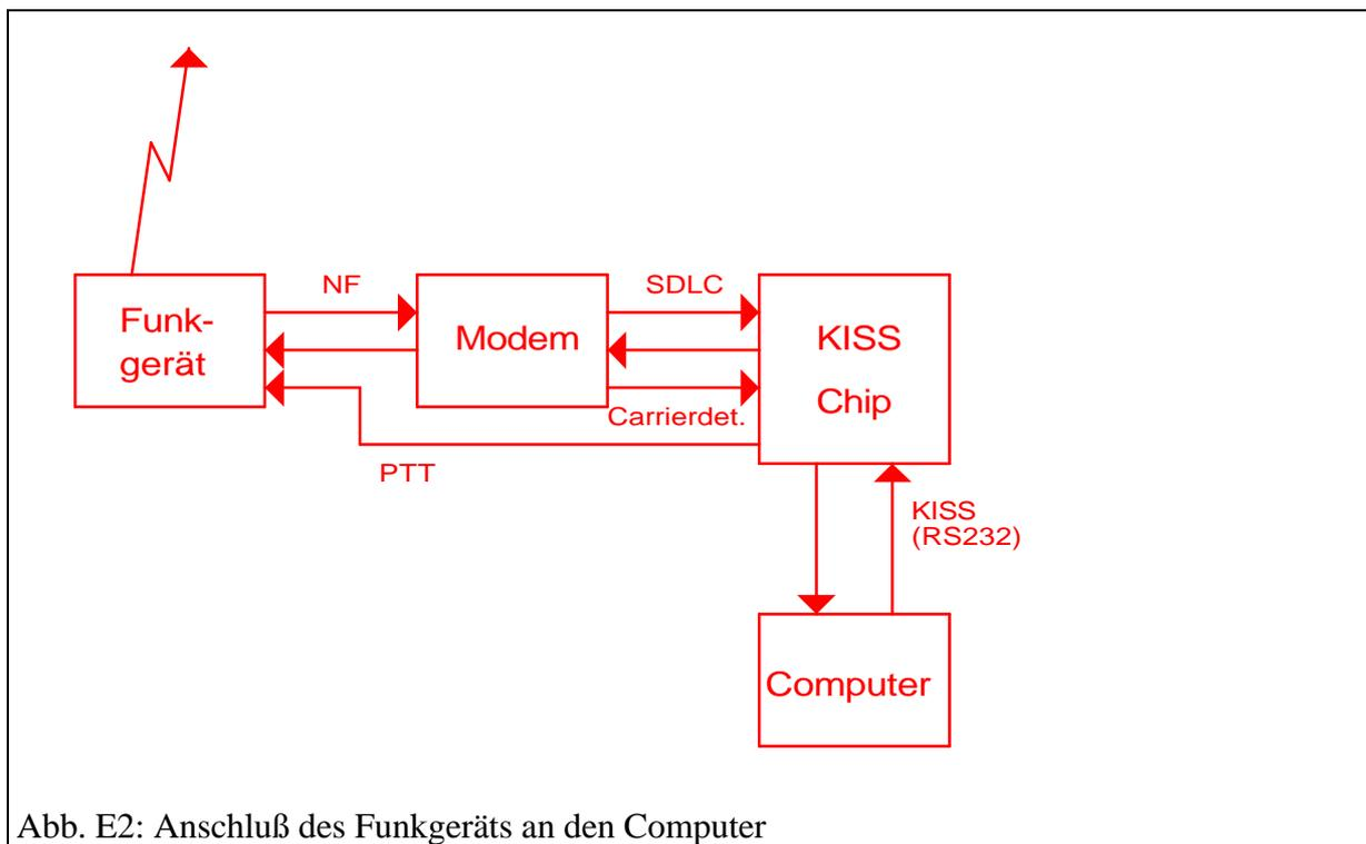
Abb. E2: Anschluß des Funkgeräts an den Computer
