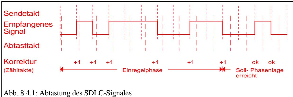
Die Veränderung der Phasenlage kann durch kurzzeitige geringfügige Erhöhung oder Erniedrigung der Frequenz geschehen. Eine Möglichkeit dies zu tun ist es, bei Herabteilung der Quarzfrequenz auf die Sollfrequenz, zur Phasenkorrektur wahlweise kurzzeitig den Divisor zu erhöhen oder zu erniedrigen. Damit dies immer in definierten Abständen vorgenommen werden kann, liefert der Baudratengenerator ein Vielfaches der Baudrate.
