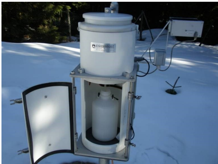
Abbildung 5: Wet-only-Sammler der Firma Eigenbrodt. Im oberen Teil befindet sich der Auffangtrichter, welcher bei fehlendem Niederschlag durch einen Deckel geschützt wird. Rechts im Bild befindet sich der optische Sensor. Unten im Bild ist die 5 L Sammelflasche zu sehen
