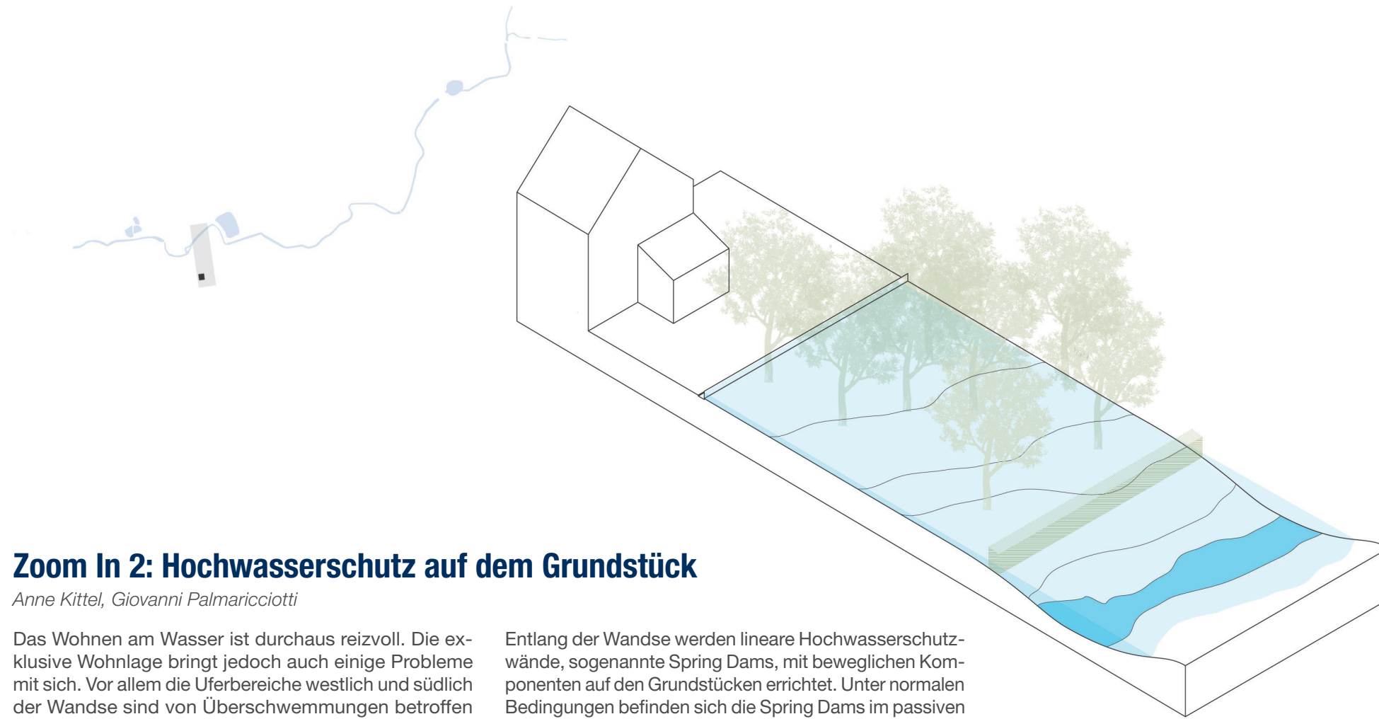
Abb. 91: Isometrie: aktivierter Spring Dam bei Hochwasser
