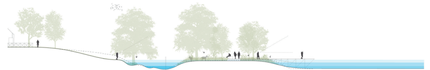
Abb. 74: Schnitt: neue Geländemodellierung schafft mehr Retentionsraum, Wandsepfad erschließt das Ufer des Ostender Teiche
