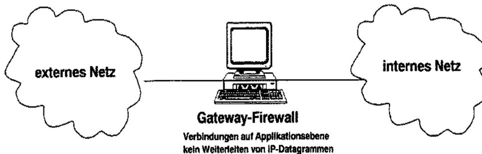
Abbildung 7.4: Gateway Firewall: konzeptionelle Sicht (Aus [Benecke et al. 98]).
