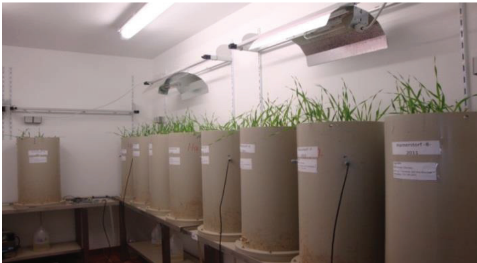
Abb. 7-9: Bepflanzte Lysimeter mit jeweils einem Saugspannungsnehmer (Tensiometer) und Temperaturfühler pro Variante
