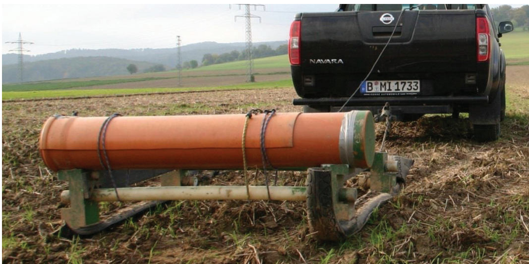
Abb. 10-2: Messung der elektrischen Leitfähigkeit mit einem EM 38 Gerät bis ca. 1,50 m Bodentiefe
