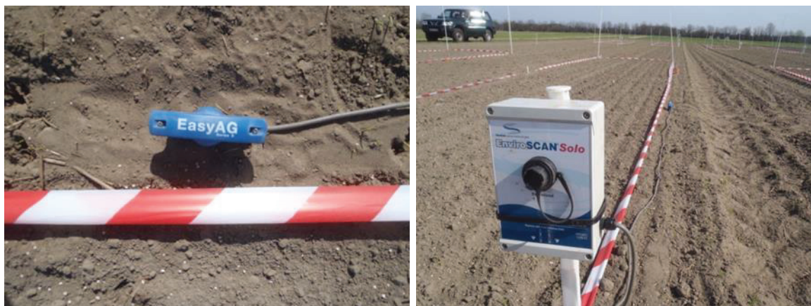
Abb. 7-2: Sentec Easy AG Messsonde 50 cm (links) und Datenspeicher (rechts)
