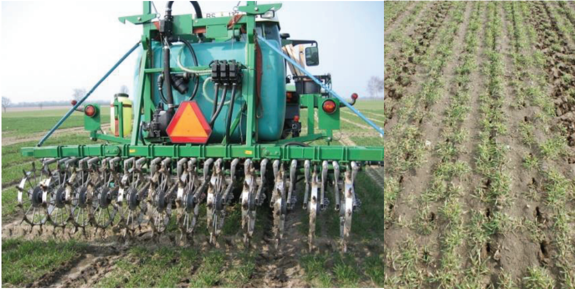
Abb. 6-1: Sternrad mit „Spokes“ zur punktförmigen Injektion der Ammoniumlösung in den Boden
