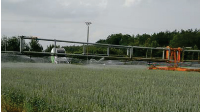
Abb. 9-2: Mobile Rohrtrommelberechnungsmaschine mit Düsenwagen in den Versuchen
