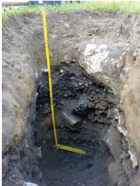
Abb. 4.2.8: Regosol aus umgelagerten fluviatilen Sand/ Sandlöss mit Bauschuttbeimengungen über Siedlungs- und Straßenbauschutt (Bottrop) (Foto: ahu AG / Bönsch & Schomers)
