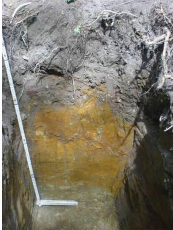
Abb. 4.2.7: Regosol aus Sand und Bauschutt über Spülmaterialeinlagerung mit Stauwassereinfluss (Bottrop) (Foto: ahu AG / Bönsch & Schomers)
